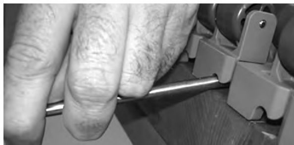
Rysunek 193: Wsuniecie pinu stalowego przez zawias
