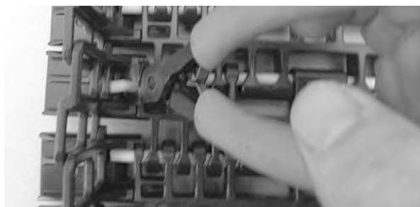
Rysunek 367: Wciśnij pin za element retencyjny
