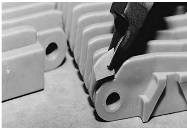
Rysunek 47: Odcięcie zewnętrznego żebra
