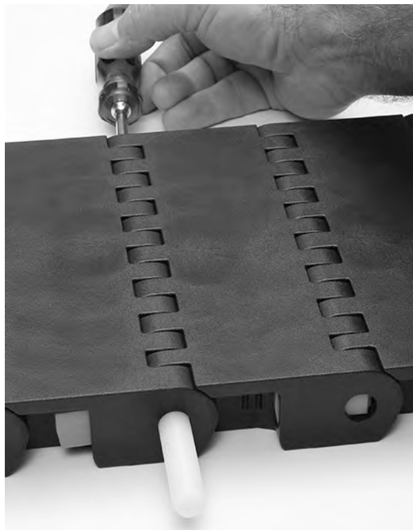
Rysunek 259: Wypchnięcie pinu z taśmy
