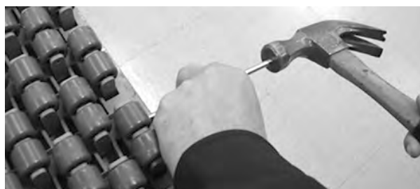
Rysunek 194: Wypchnięcie pinu z taśmy
