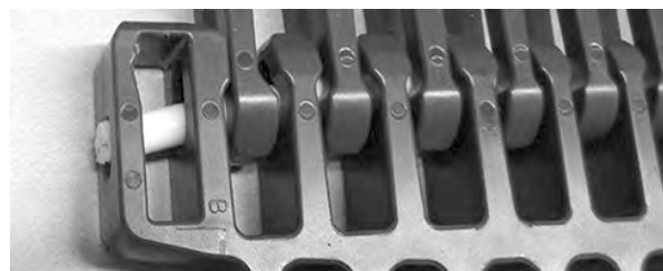
Rysunek 331: Wsuwanie pinu przez zawiasy
