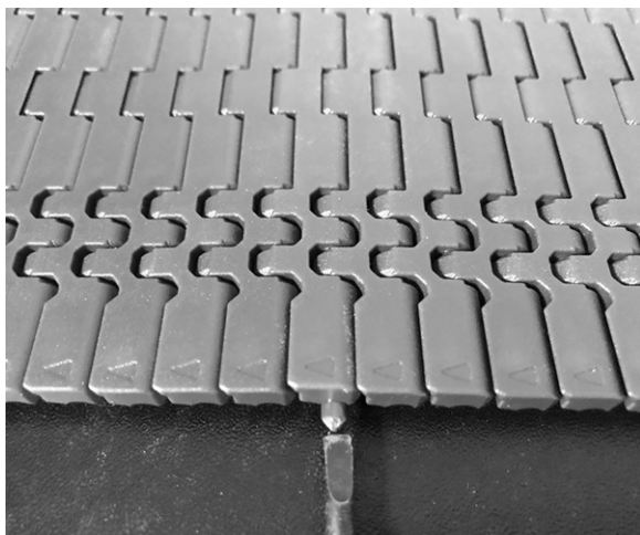
Rysunek 59: Wciśnij pin za element retencyjny
