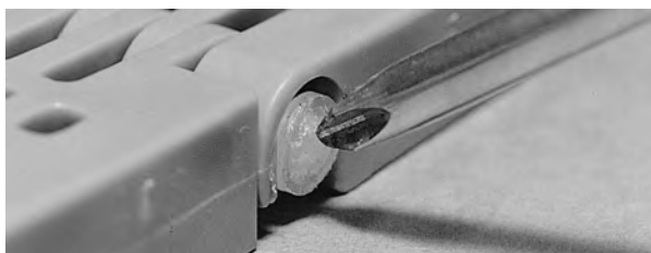
Rysunek 38: Upewnienie się, że pin znajduje się za zapięciem zatrzaskowym
