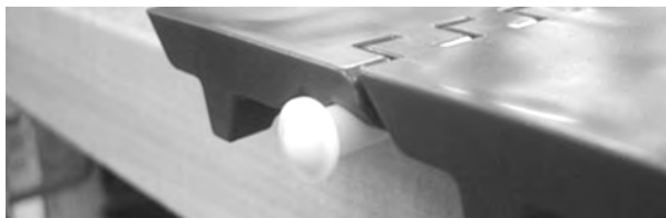
Rysunek 96: Wsuwanie pinu przez zawiasy
