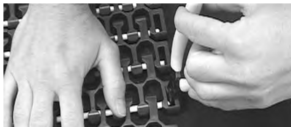
Rysunek 309: Wciśnięcie pinu do taśmy
