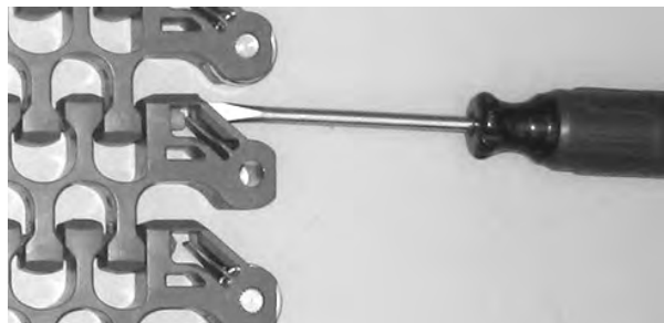
Rysunek 298: Otwieranie elementu retencyjnego
