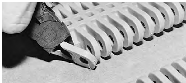
Rysunek 46: Odcięcie zewnętrznego ogniwa
