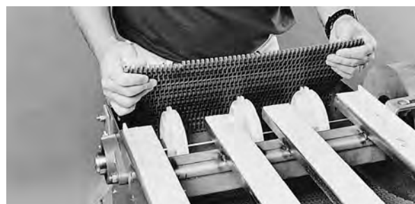
Rysunek 11: Przesuwanie taśmy przez sekcję powrotną przenośnika
