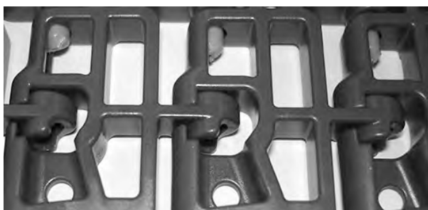
Rysunek 116: Wsunięcie się pinów w gładki brzeg
