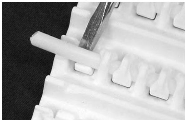
Rysunek 176: Unoszenie pinu ponad element retencyjny
