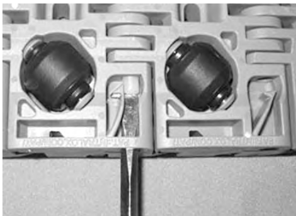
Rysunek 225: Wciśnij pin za element retencyjny
