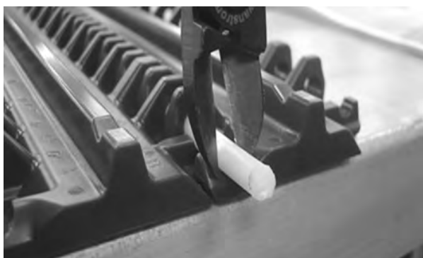
Rysunek 72: Wyciągnij pin z taśmy
