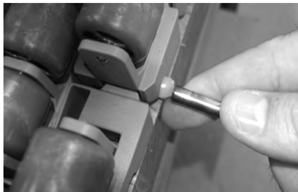
Rysunek 190: Wciśnij pin za element retencyjny
