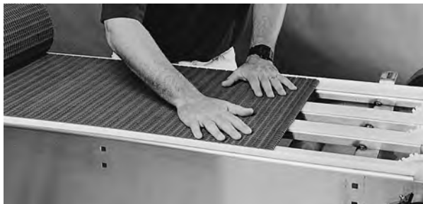
Rysunek 8: Przesuwanie taśmy od końca napędowego
