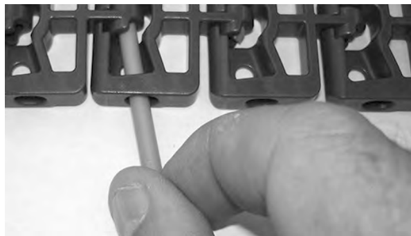
Rysunek 122: Wsuwanie pinu przez zawiasy
