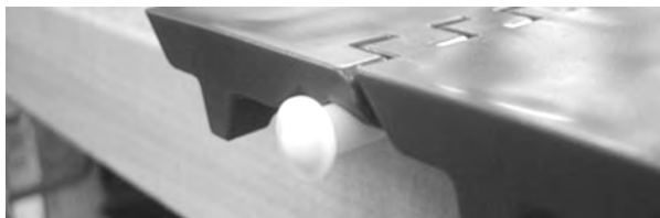
Rysunek 67: Wsuwanie pinu przez zawiasy
