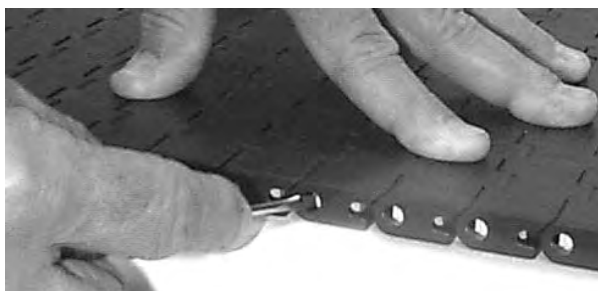
Rysunek 163: Otwieranie elementu Slidelox
