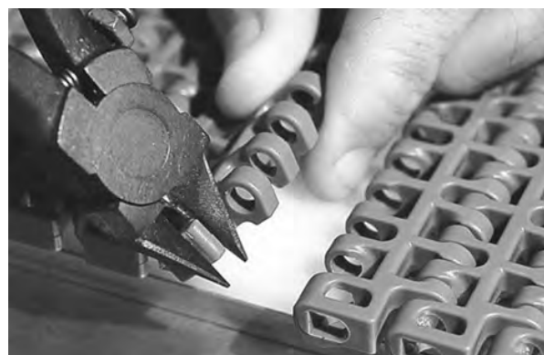
Rysunek 152: Odcięcie brzegu taśmy
