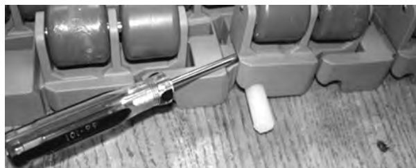
Rysunek 195: Wyciągnięcie pinu z taśmy
