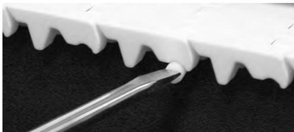
Rysunek 174: Wciśnij pin za element retencyjny
