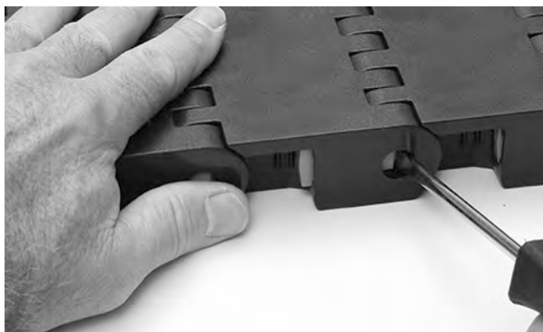
Rysunek 257: Otwieranie elementu Slidelox
