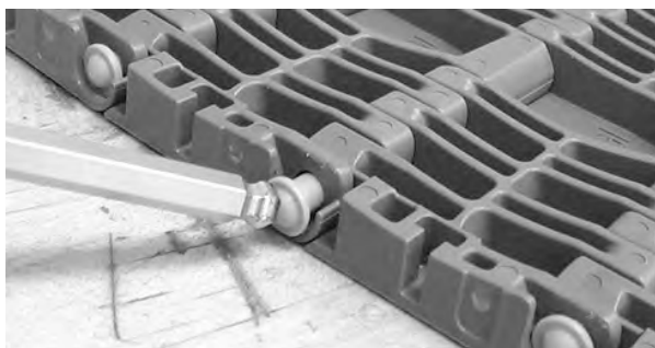
Rysunek 267: Wcisnięcie pinu krótkiego za element retencyjny
