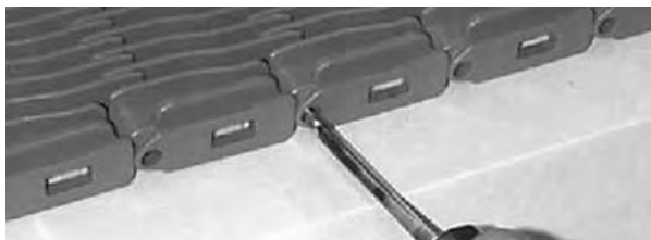
Rysunek 44: Wypchnięcie pinu z taśmy
