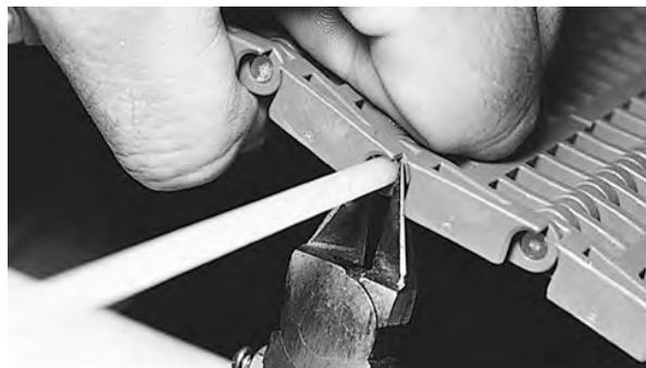
Rysunek 113: Przycięcie pinu równo z brzegiem taśmy
