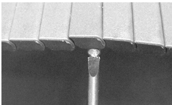
Rysunek 54: Wciśnięcie łba piny przez element retencyjny
