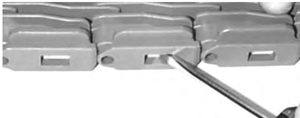
Rysunek 42: Zamykanie elementu Slidelox
