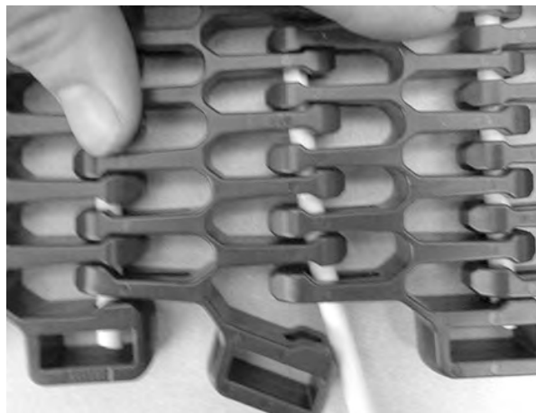
Rysunek 324: Wyrównanie zawiasów
