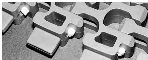
Rysunek 272: Upewnienie się, że pin jest całkowicie wsunięty
