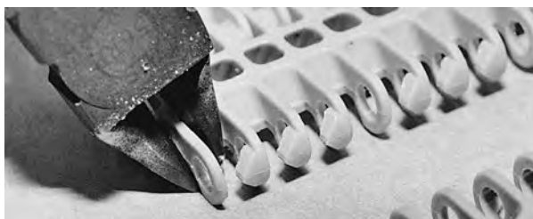
Rysunek 26: Odcięcie zewnętrznego ogniwa
