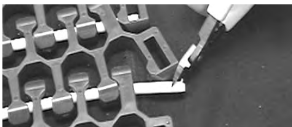
Rysunek 312: Wyciągnij pin z taśmy
