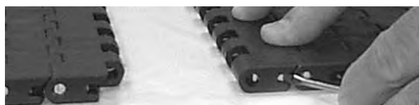
Rysunek 160: Zamknięcie elementu Slidelox za pomocą wkrętaka
