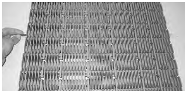
Rysunek 217: Otwieranie elementu Shuttleplug
