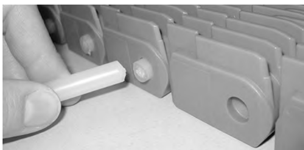
Rysunek 216: Wciskanie pinu przez element Shuttleplug
