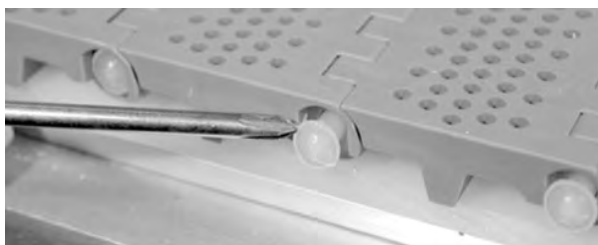
Rysunek 63: Wciśnięcie pinu do taśmy
