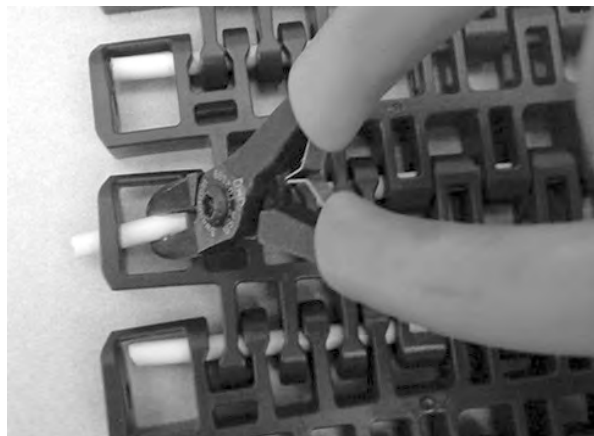
Rysunek 357: Wciśnij pin za element retencyjny
