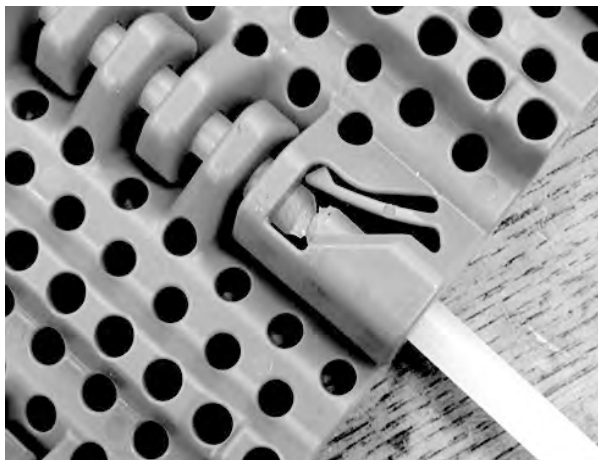
Rysunek 85: Wciśnij pin za element retencyjny
