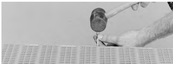
Rysunek 32: Wypchnięcie pinu z taśmy
