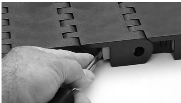
Rysunek 256: Zamykanie elementu Slidelox
