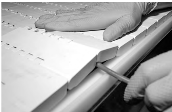
Rysunek 88: Lekkie zgięcie i wsunięcie pinu przez zawiasy
