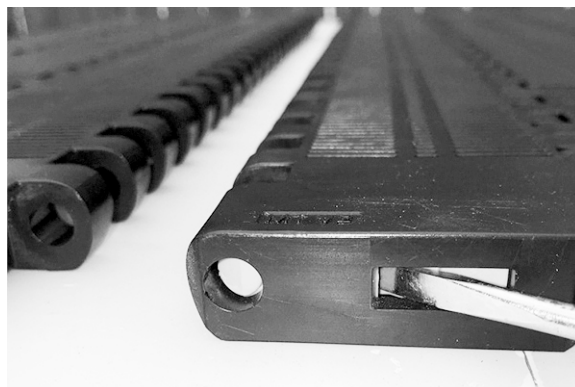
Rysunek 211: Zamykanie elementu Slidelox
