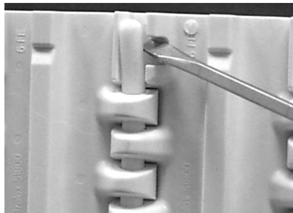
Rysunek 206: Unoszenie pinu ponad element retencyjny
