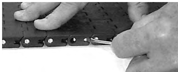
Rysunek 165: Zamykanie elementu Slidelox
