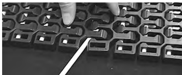
Rysunek 304: Wsuwanie pinu przez zawiasy
