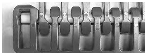
Rysunek 332: Upewnienie się, że pin znajduje się za elementem retencyjnym
