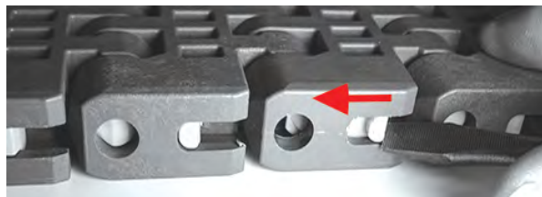
Rysunek 158: Zamykanie elementu Slidelox
