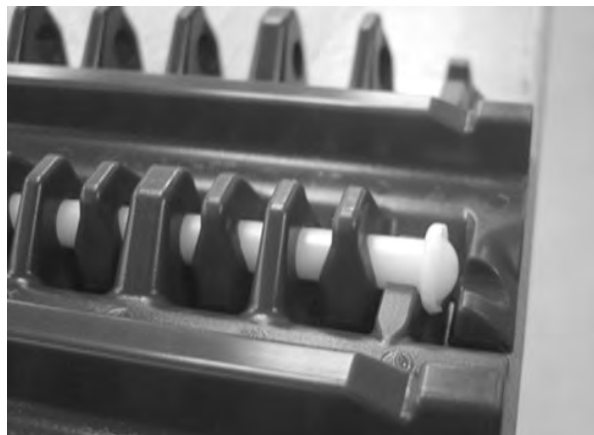
Rysunek 99: Upewnienie się, że pin znajduje się za elementem retencyjnym
