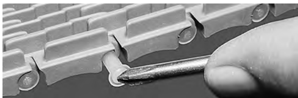
Rysunek 22: Wciśnięcie pinu do taśmy
