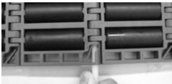
Rysunek 236: Wsuwanie pinu przez zawiasy
