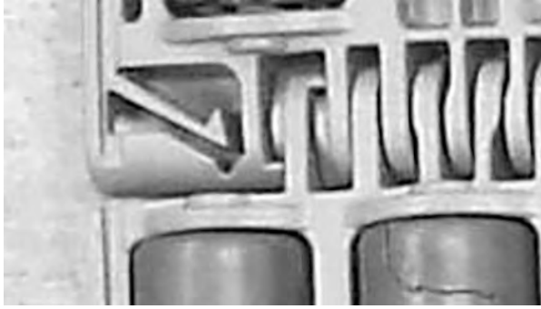
Rysunek 223: Upewnienie się, że pin znajduje się za elementem retencyjnym
