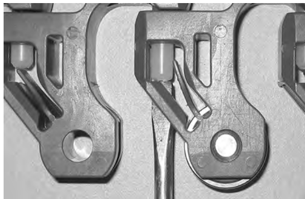
Rysunek 300: Wciśnij pin za element retencyjny
