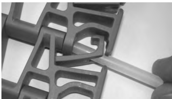
Rysunek 246: Wsuwanie pinu przez zawiasy
