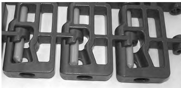
Rysunek 117: Zwiększenie wielkości pinu w gładkim brzegu
