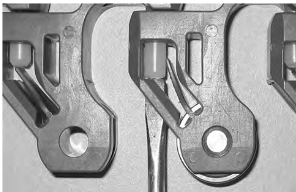
Rysunek 278: Wciśnij pin za element retencyjny
