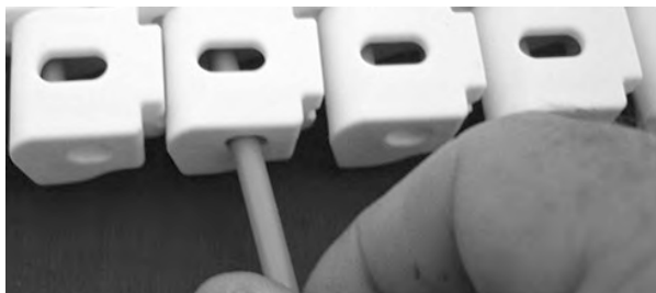
Rysunek 282: Wsuwanie pinu przez zawiasy
