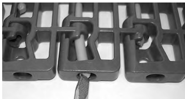
Rysunek 123: Wciśnij pin za element retencyjny
