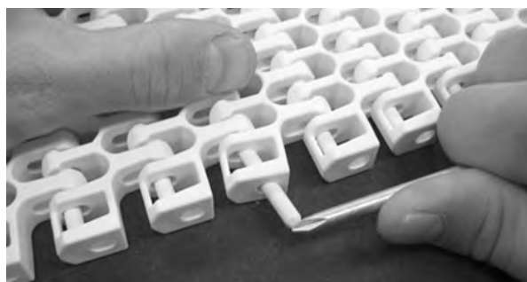
Rysunek 288: Wciśnij pin za element retencyjny
