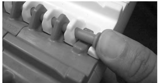
Rysunek 77: Wciśnij pin za element retencyjny
