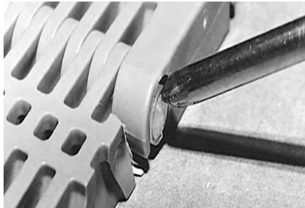
Rysunek 48: Wciśnięcie łba pinu przez element retencyjny
