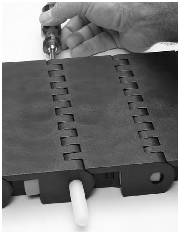
Rysunek 263: Wypchnięcie pinu z taśmy
