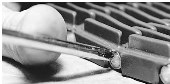
Rysunek 112: Upewnienie się, że pin znajduje się za zapięciem zatrzaskowym
