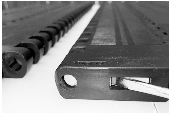
Rysunek 214: Zamykanie elementu Slidelox
