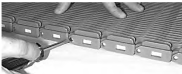
Rysunek 43: Otwieranie elementu Slidelox
