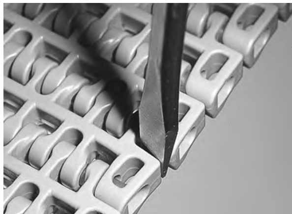
Rysunek 138: Wciśnij pin za element retencyjny
