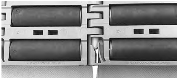
Rysunek 241: Wciśnij pin za element retencyjny
