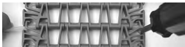
Rysunek 250: Wypchnięcie pinu z taśmy
