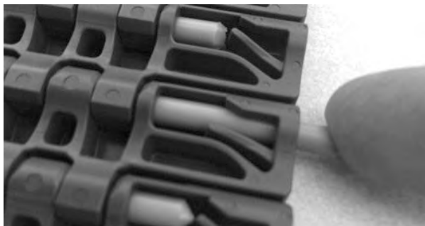
Rysunek 127: Wsuwanie pinu przez zawiasy
