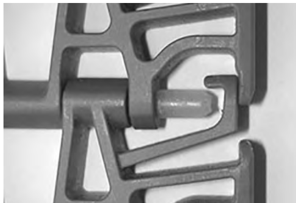
Rysunek 248: Upewnienie się, że pin znajduje się za elementem retencyjnym
