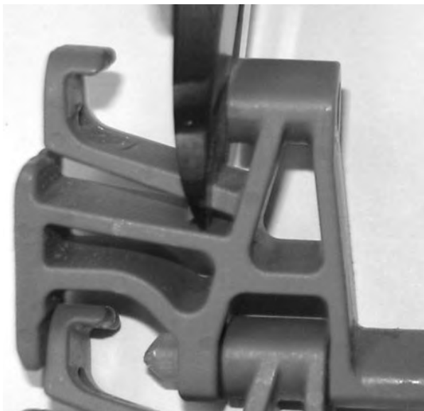
Rysunek 252: Odcięcie elementu retencyjnego
