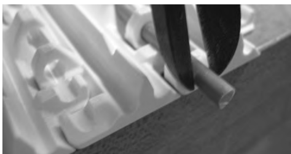
Rysunek 183: Wyciągnij pin z taśmy
