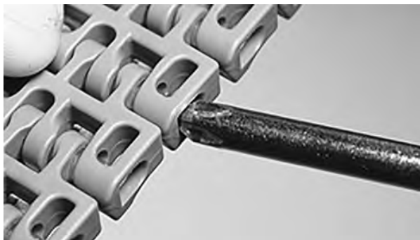
Rysunek 136: Wciśnij pin za element retencyjny
