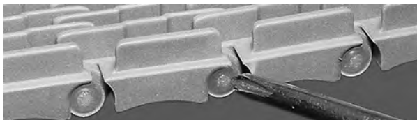
Rysunek 23: Upewnienie się, że pin znajduje się za zapięciem zatrzaskowym
