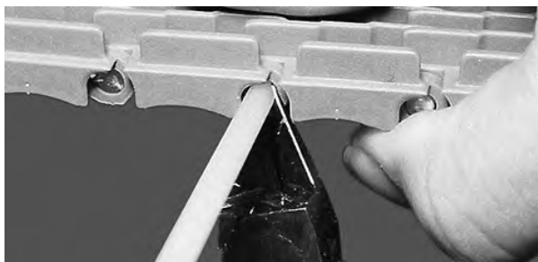
Rysunek 24: Przycięcie pinu równo z brzegiem taśmy
