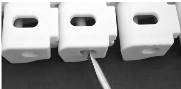
Rysunek 283: Wciśnij pin za element retencyjny
