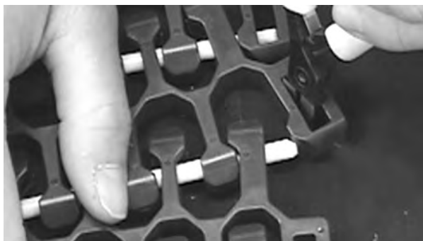
Rysunek 310: Odginanie brzegu modułu w celu zwolnienia pinu
