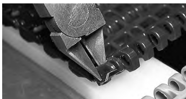
Rysunek 150: Odcięcie elementu brzegowego
