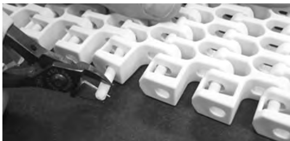
Rysunek 291: Wyciągnięcie pinu z taśmy
