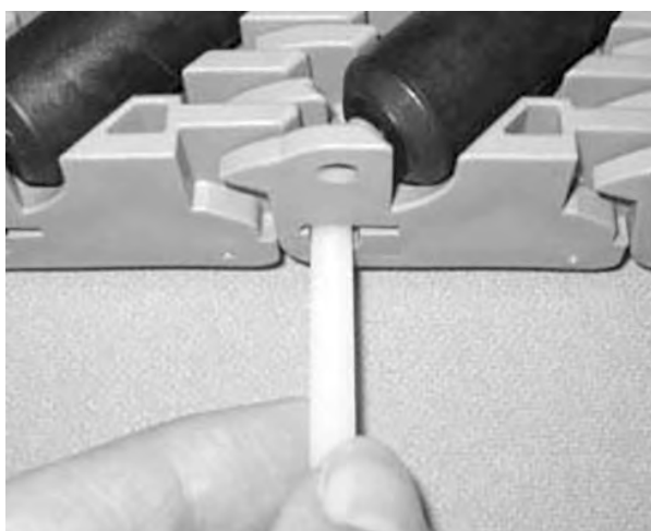
Rysunek 230: Wsuwanie pinu przez zawiasy
