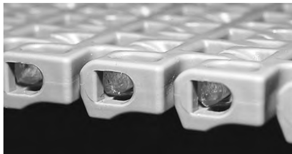
Rysunek 146: Upewnienie się, że pin znajduje się za elementem retencyjnym
