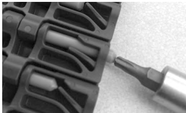
Rysunek 128: Wciśnij pin za element retencyjny
