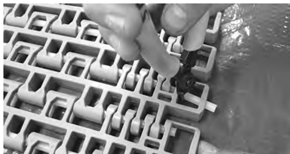
Rysunek 340: Wyciągnij pin z taśmy
