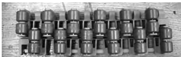
Rysunek 189: Przeprowadzenie montażu co dwa rzędy
