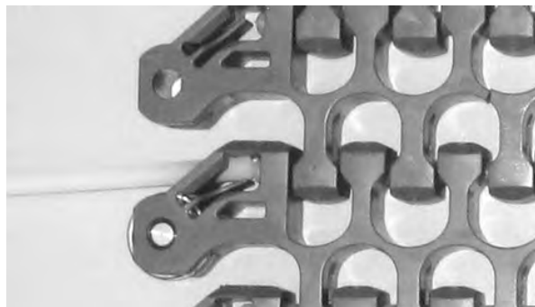
Rysunek 281: Wypchnięcie pinu z taśmy
