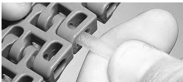
Rysunek 144: Wsuwanie pinu przez zawiasy
