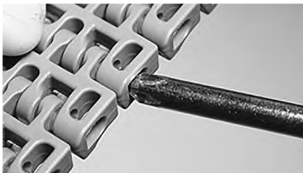
Rysunek 145: Wciśnij pin za element retencyjny
