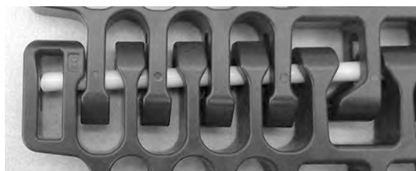
Rysunek 315: Upewnienie się, że pin znajduje się za elementem retencyjnym
