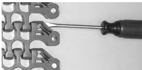
Rysunek 280: Otwieranie elementu retencyjnego
