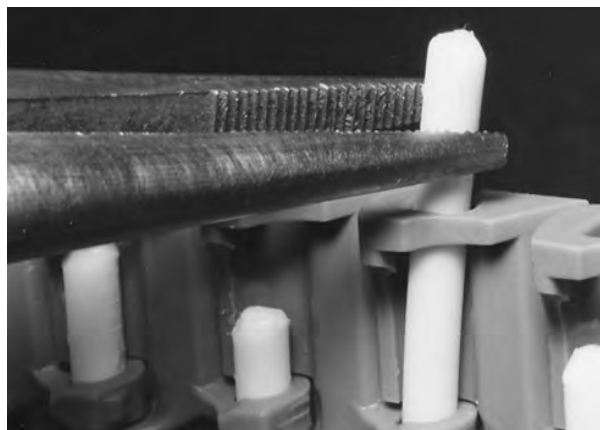
Rysunek 149: Wyciągnięcie pinu z taśmy
