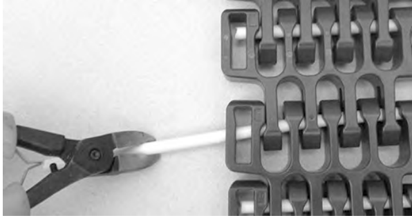
Rysunek 317: Wyciągnięciu piny z taśmy
