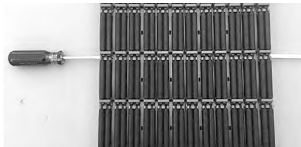
Rysunek 243: Wypchnięcie pinu z taśmy
