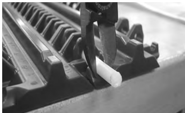
Rysunek 101: Wyciągnij pin z taśmy
