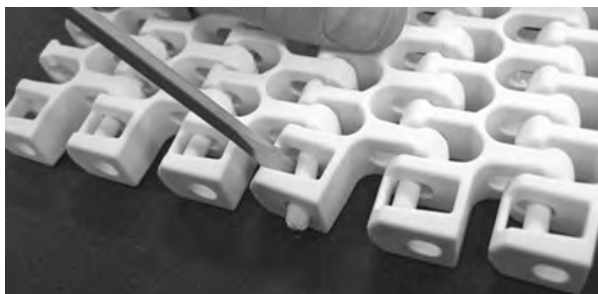
Rysunek 290: Wciskanie pinu przez element retencyjny
