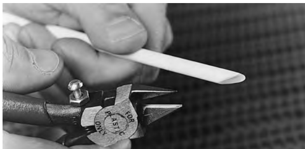
Rysunek 14: Przycięcie pinu pod kątem
