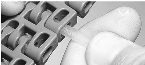
Rysunek 135: Wsuwanie pinu przez zawiasy
