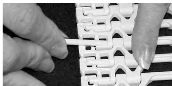
Rysunek 169: Wsuwanie pinu przez zawiasy
