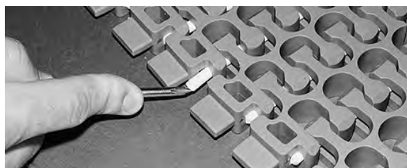
Rysunek 271: Upewnienie się, że pin znajduje się za elementem retencyjnym
