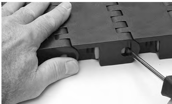
Rysunek 260: Otwieranie elementu Slidelox
