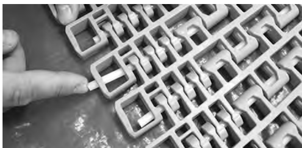
Rysunek 338: Wciśnij pin za element retencyjny
