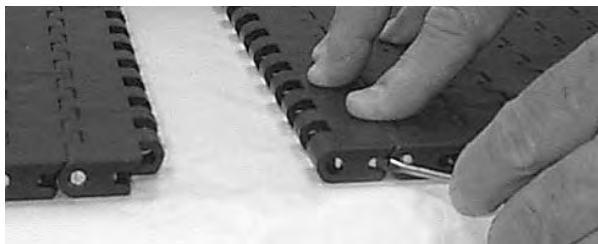
Rysunek 162: Zamykanie elementu Slidelox
