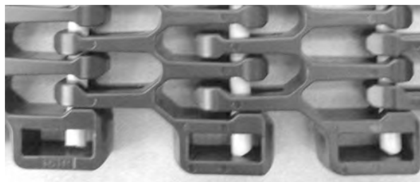
Rysunek 326: Upewnienie się, że pin jest całkowicie wsunięty
