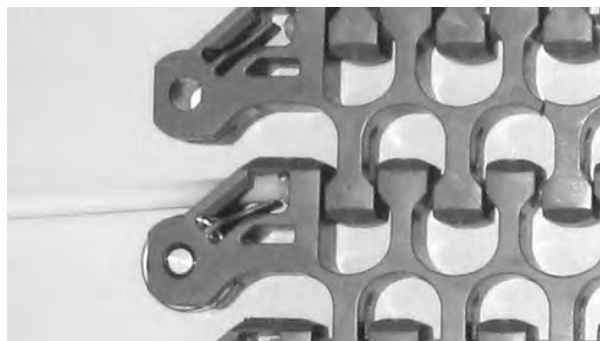
Rysunek 299: Wyciągnij pin z taśmy
