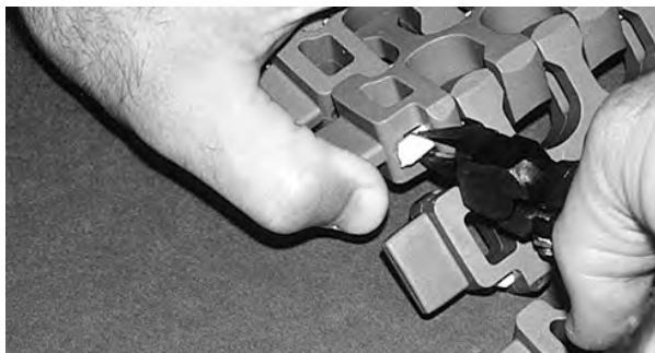
Rysunek 273: Zwolnienie pinu z elementu retencyjnego
