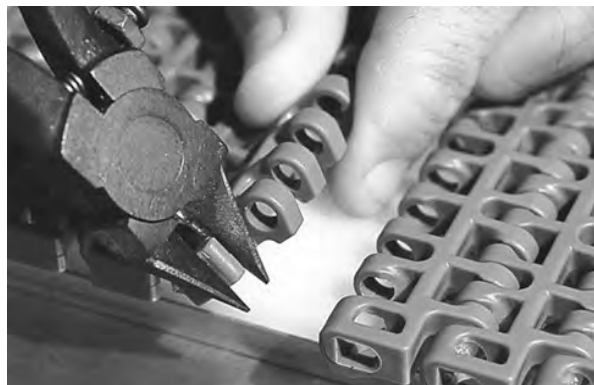
Rysunek 142: Odcięcie brzegu taśmy
