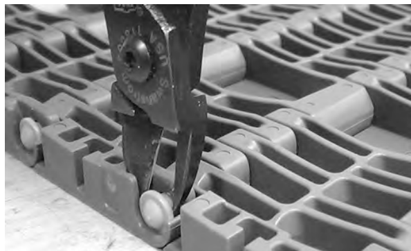
Rysunek 268: Przycięcie krótkiego pinu
