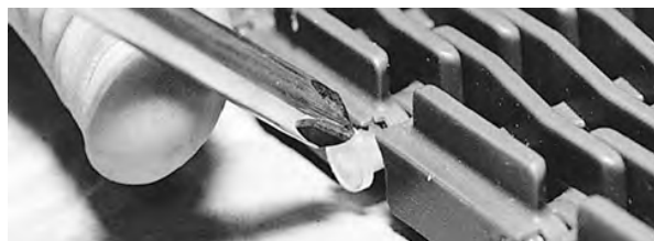
Rysunek 111: Wciśnięcie pinu do taśmy
