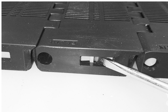
Rysunek 212: Otwieranie elementu Slidelox
