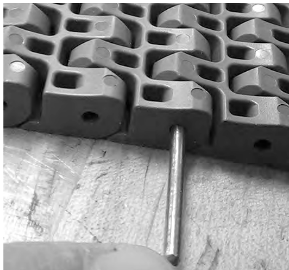
Rysunek 269: Wypchnięcie pinu i pinu krótkiego z taśmy
