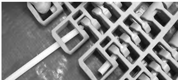
Rysunek 337: Wsuwanie pinu przez zawiasy
