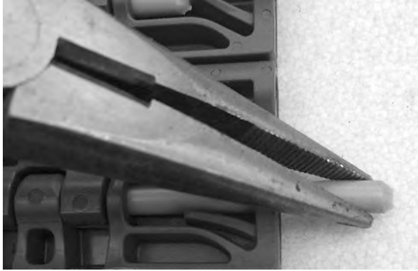
Rysunek 131: Wyciągnij pin z taśmy
