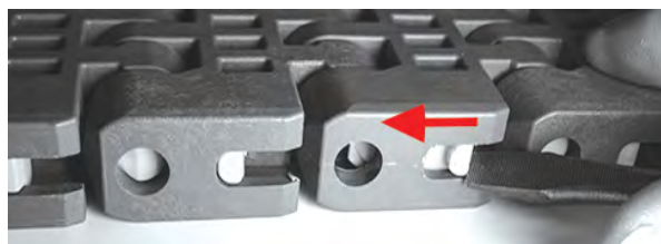
Rysunek 156: Zamykanie elementu Slidelox
