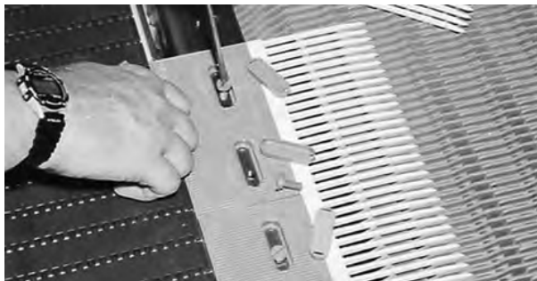
Rysunek 18: Mocowanie palcowych płytek transferowych przy użyciu śrub Intralox z tworzywa sztucznego
