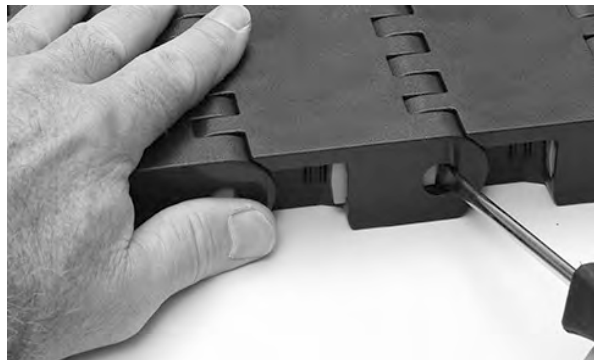
Rysunek 262: Otwieranie elementu Slidelox
